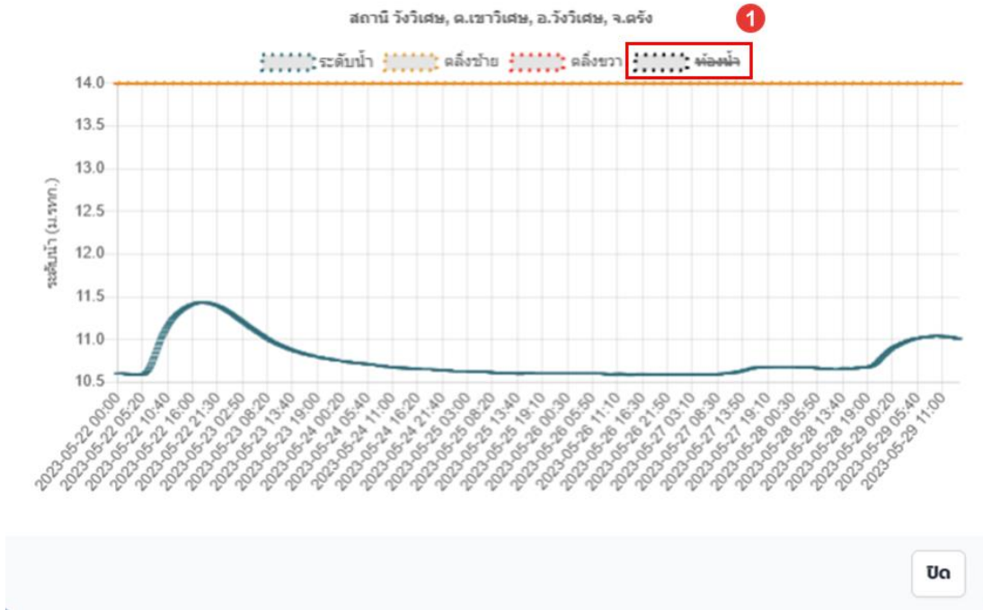
รูปที่ 2.3.2-4 การซ่อนการแสดงผลข้อมูลท้องน้ำของสถานีวังวิเศษในรูปแบบกราฟ
